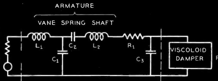
EQUIVALENT ELECTRICAL CIRCUIT FOR MECHANICAL RECORDER
