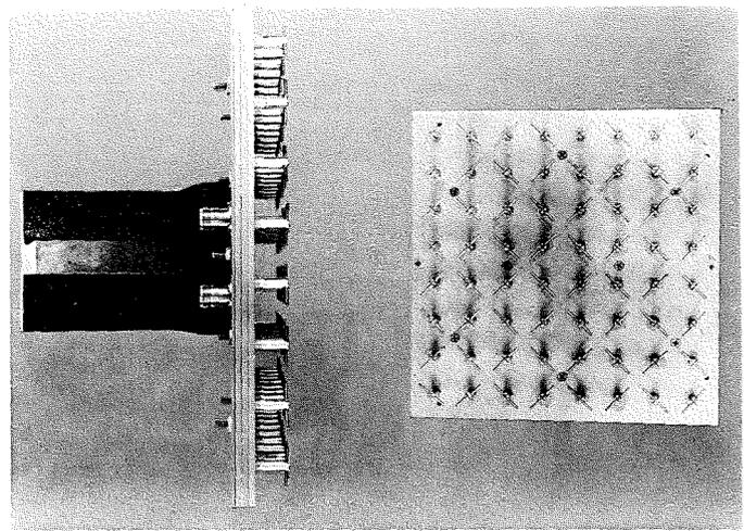
Fig. 5—Circular-grid array antenna element (antennule).
