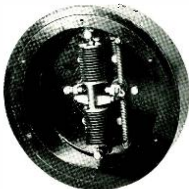
Fig. 8—Sylphon damping arrangement L. A. Elmer.
