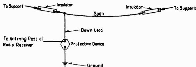
Fig. 4—Diagrammatic Antenna
