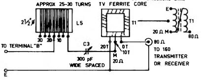
FIG 2 ANTENNA TUNING UNIT FOR 160 METRES
