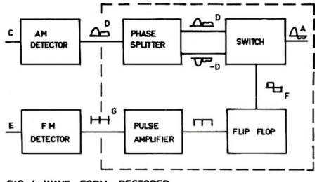
FIG 4 WAVE FORM RESTORER
