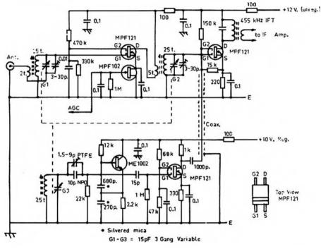
FIGURE 1, CIRCUIT DIAGRAM FOR TUNABLE FRONT END
