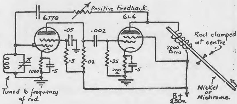
**FIG. 9 ULTRASONIC GENERATOR.**
