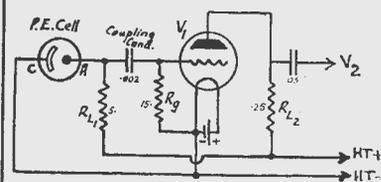
BASIC PHOTO-ELECTRIC CELL CIRCUIT.
