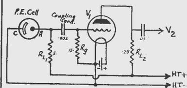
BASIC PHOTO-ELECTRIC CELL CIRCUIT.
