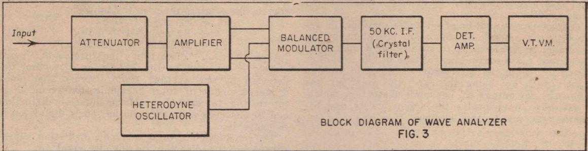
BLOCK DIAGRAM OF WAVE ANALYZER
