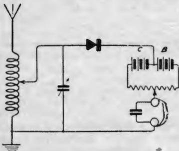
Fig. 1.—A simple potentiometer circuit.
