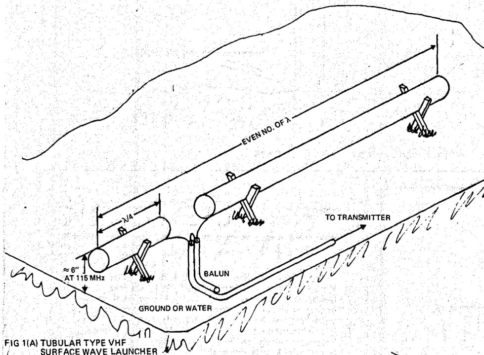
FIG 1(A) TUBULAR TYPE VHF SURFACE WAVE LAUNCHER
