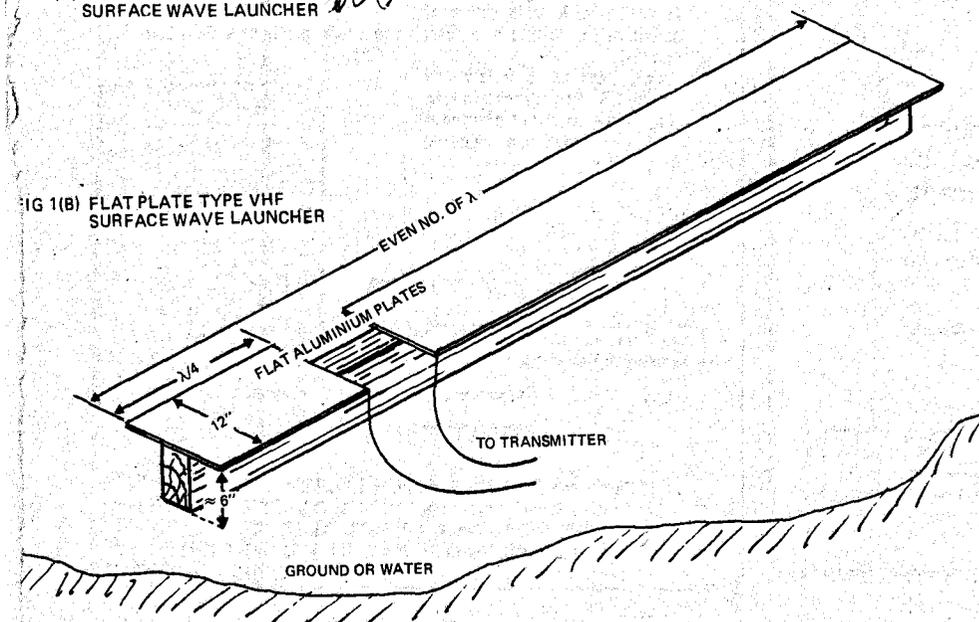
FIG 1(B) FLAT PLATE TYPE VHF SURFACE WAVE LAUNCHER
