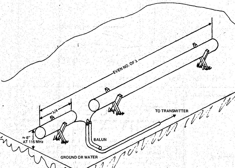
FIG 1(A) TUBULAR TYPE VHF SURFACE WAVE LAUNCHER
