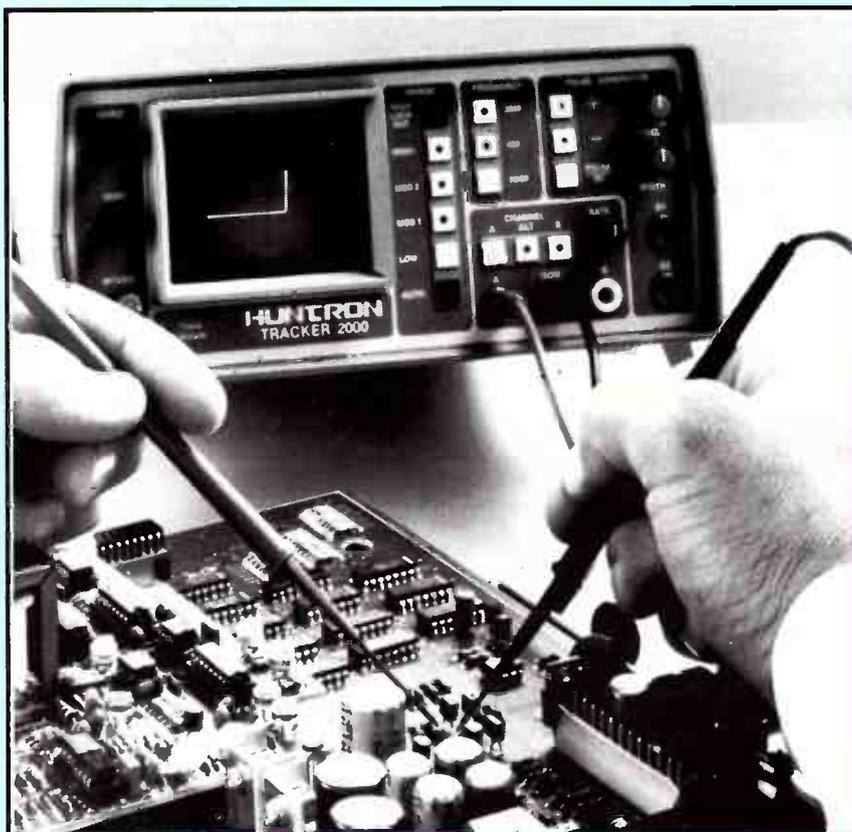
**THE HUNTRON TRACKER TESTS . . . DIODES, TRANSISTORS, LEDS, THYRISTORS, I.C.'S INCLUDING . . . CMOS, NMOS, PMOS, TTL & ANALOGUE. CAPACITORS, MEMORY COMPONENTS INCLUDING DRAMS, SRAMS, EPROMS, EEPROMS.**
