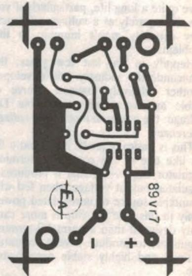
**The PCB etching pattern, actual size.**
