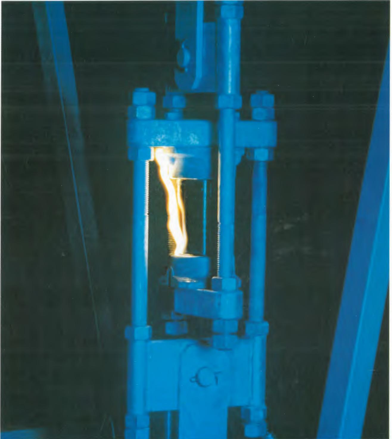
**HIGH VOLTAGE TEST ON GUY INSULATOR**
