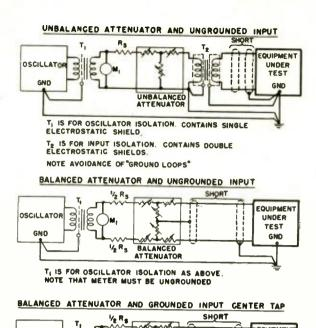
BALANCE AND GROUNDING-INPUT CIRCUITS
