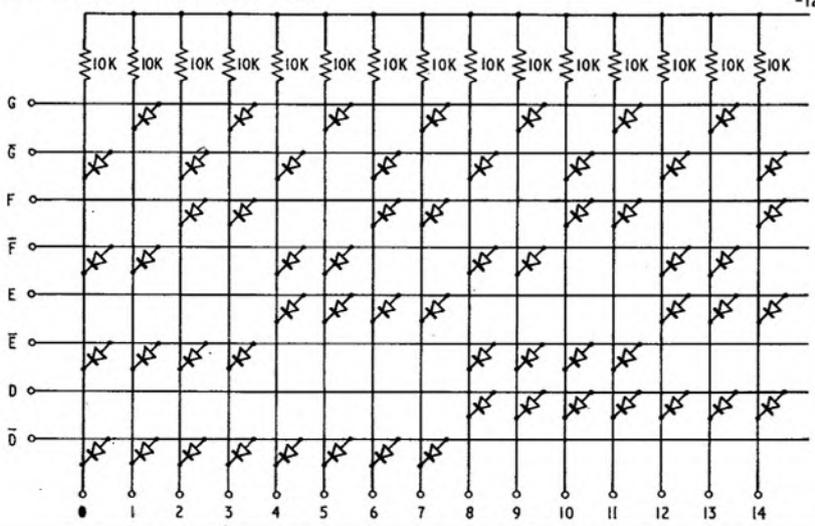
FIG. 11 KEY CONTROL CIRCUIT
