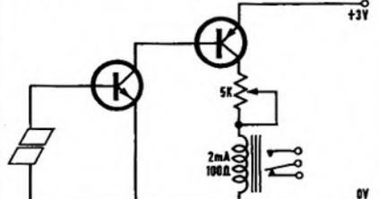
(a) SIMPLE TOUCH-PLATE RELAY CONTROL. THE RELAY MAY BE A "LATCHING" TYPE OR MAY BE USED TO CONTROL FURTHER RELAYS OF ANY TYPE.
