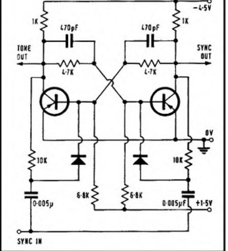
**FIG. 24 NPN-PNP RELAXATION OSCILLATOR USED AS A FREQUENCY DIVIDER**
