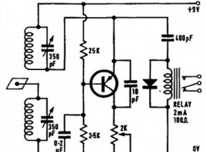
(b) HAND CAPACITY RELAY CONTROL. THE MATCHED CIRCUITS DETUNE AND THE RESULTING HETERODYNE CURRENT CLOSES THE RELAY.
