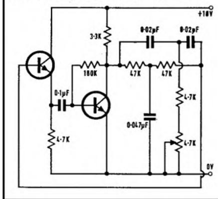
FIG. 13 WIDE-RANGE VARIABLE FREQUENCY SAWTOOTH RELAXATION OSCILLATOR USING AN N-P-N/P-N-P TRANSISTOR COMBINATION
