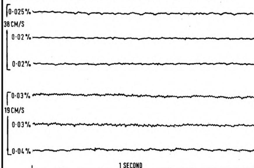
**FIG. 2** REVOX HS77/NAB PLAY-ONLY FREQUENCY RESPONSE (TEST TAPES TO LINE OUT)
