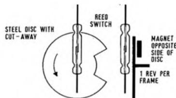
ROTATING SHUNT CAM SWITCH
