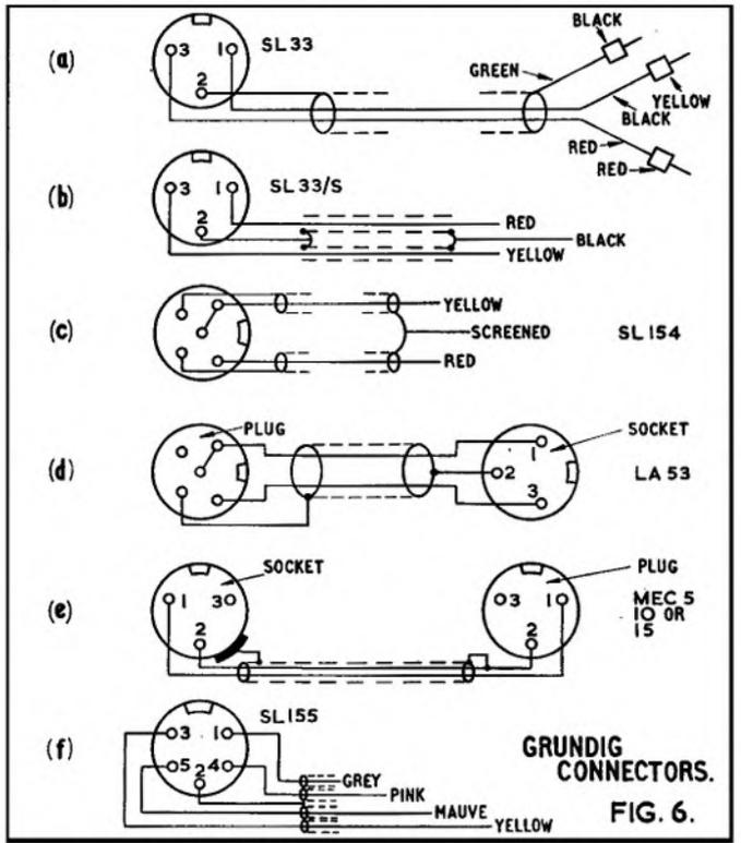
FIG. 6. GRUNDIG CONNECTORS.
