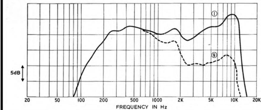
FIG. 5 GRUNDIG GDM 312 MICROPHONE (HIGH-Z)
