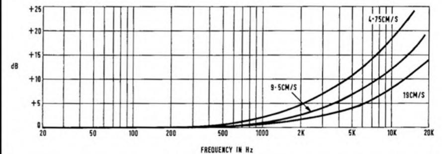
FIG. 5 OVERALL RECORD/PLAYBACK CURVES FOR CROSS-FIELD BIAS
