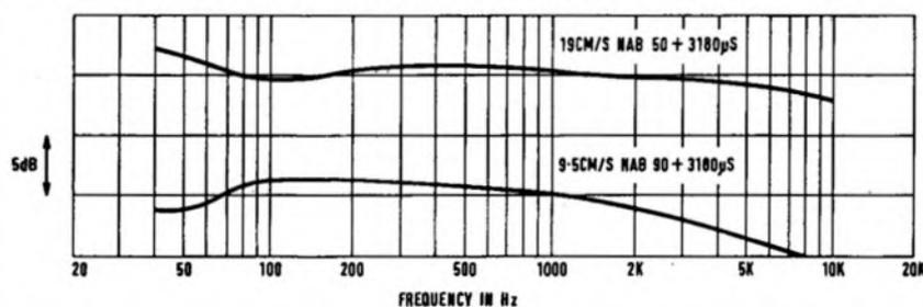
**FIG. 3 PHILIPS 4408 RECORD-PLAY FREQUENCY RESPONSE (LINE IN, PHILIPS LP, LINE OUT)**
