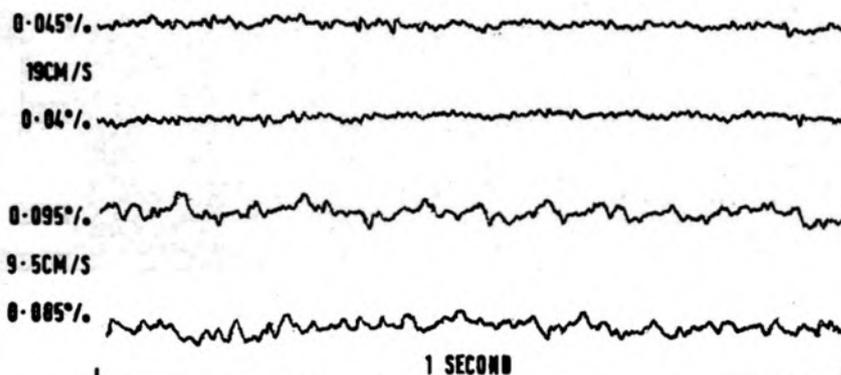
**FIG. 2 PHILIPS 4408 PLAY-ONLY FREQUENCY RESPONSE (TEST TAPES TO LINE OUT)**
