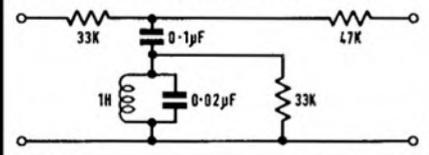
**FIG. 54** HORN. A SIMPLE LIGHTLY-DAMPED RESONANT FILTER.  $f_r$  AROUND 350Hz
