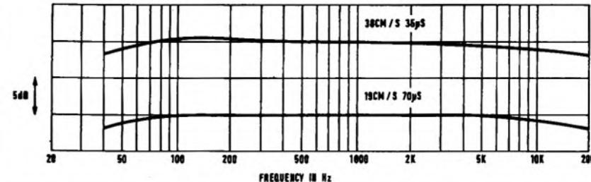
**FIG. 3 TELEFUNKEN M28C RECORD-PLAY FREQUENCY RESPONSE (LINE IN TO LINE OUT)**
