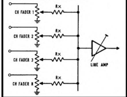
FIG. 10 30dB LINE AMP (POSITIVE EARTH)
