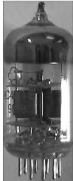
PHOTO 2: The 6C45-IIЕ triode.
