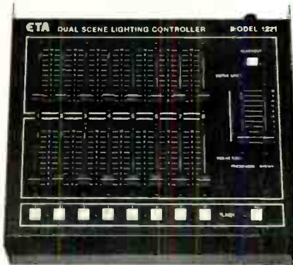
ETA 1221 dual-scene lighting controller
