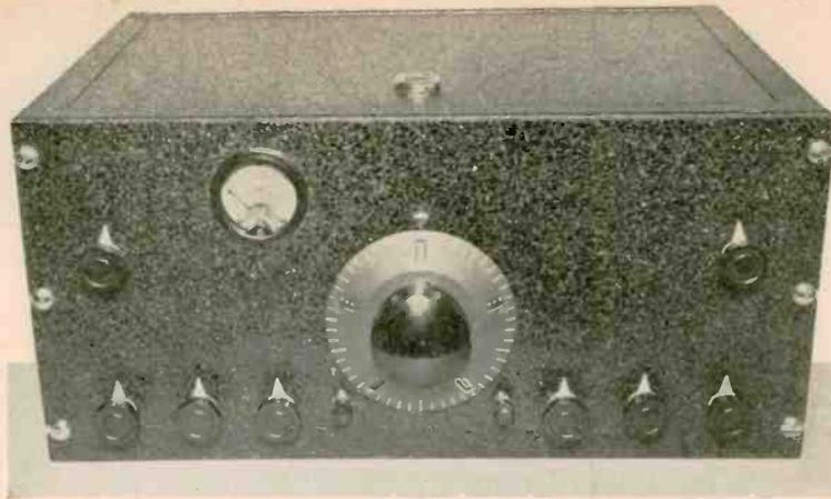
FRONT-PANEL VIEW OF 2TP's 10-20-METER SUPERHETERODYNE
