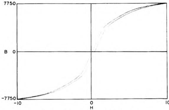
Fig. 4—Hysteresis loop of annealed iron.
