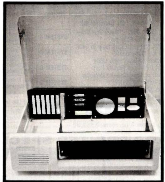
OUR **MEGA-CASE™** IS MADE EXCLUSIVELY FOR THE **MEGA-BOARD™ XT**. THE **MEGA-CASE™** REQUIRES A POWER SUPPLY WITH THE SWITCH IN THE REAR. THE FLIP TOP ASSURES EASY ACCESS TO THE MEGABOARD™ XT.
