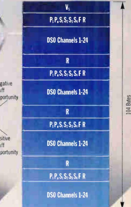
**Floating Byte-Synchronous DS1 Mapping**
