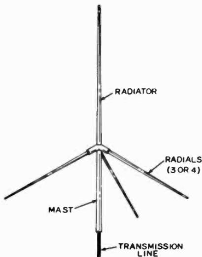
Fig. 5-3. Ground-plane antenna.
