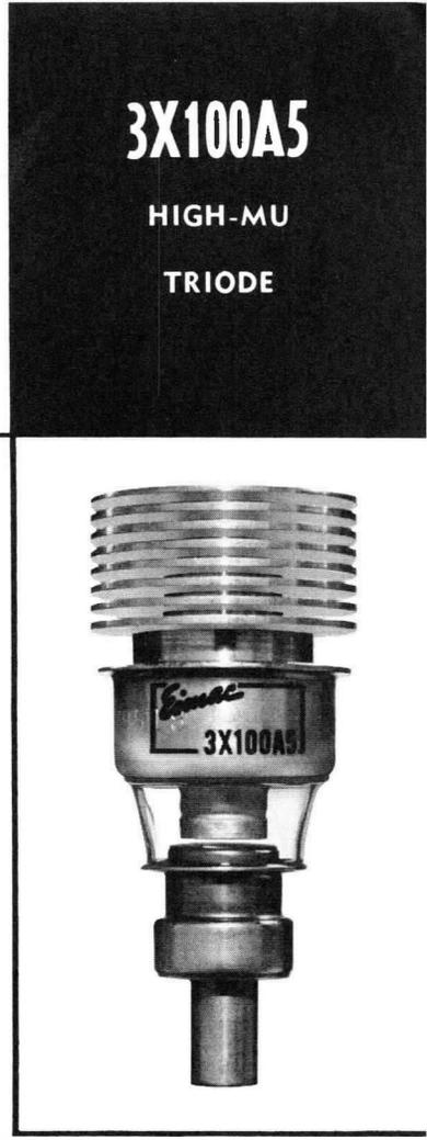
**RADIO-FREQUENCY POWER AMPLIFIER, OR OSCILLATOR**
