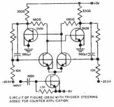
TRIGGER CIRCUITS USING TRIGGER POWER TO INCREASE SWITCHING SPEED FIGURE 126(C)
