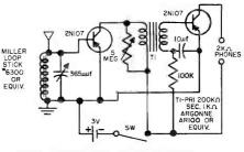
TWO TRANSISTOR RADIO RECEIVER FIGURE 68
