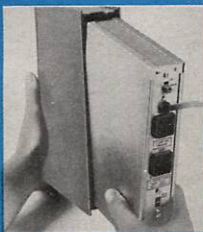
Alle Schalter und Steckdosen sind auf der Rückseite des Gerätes angebracht.
