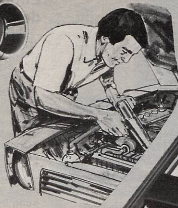
Mißt Motordrehzahl, Schließwinkel und Gleichspannung
