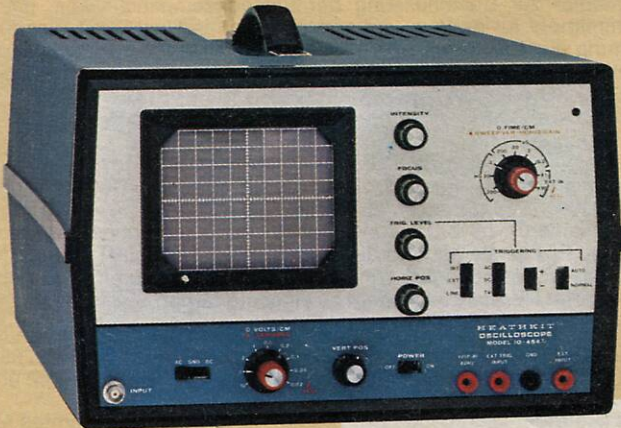
IO-4541 DC-5 MHz, 20 mV Einkanal-Oszilloskop – siehe Seite 30
