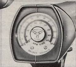
Eingebauter Drehzahlmesser und Zündzeitpunktkontrolle
