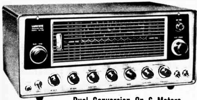
NEW "ALWAYS ON" FILAMENT VOLTAGE IN MIXER AND OSCILLATOR STAGES FOR FREQUENCY STABILITY!
