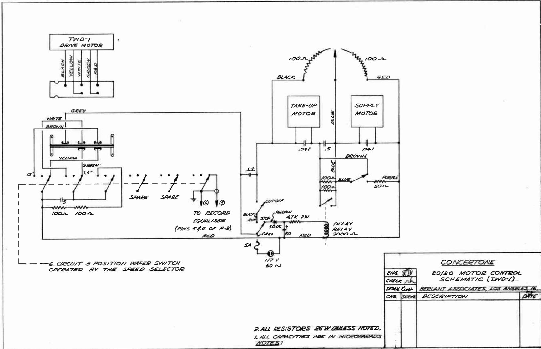
Fig. 8 SCHEMATIC, DRIVE TWD
