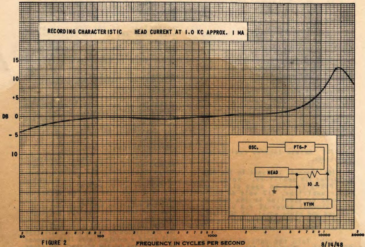
MAGNETIC TAPE RECORDING AMPLIFIER CHARACTERISTIC
