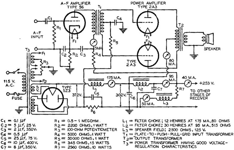
NOTE. A SPEAKER SPECIALLY DESIGNED FOR HIGH POWER IS RECOMMENDED. CIRCUIT CONSTANTS SHOULD CLOSELY APPROXIMATE THOSE GIVEN ABOVE.
