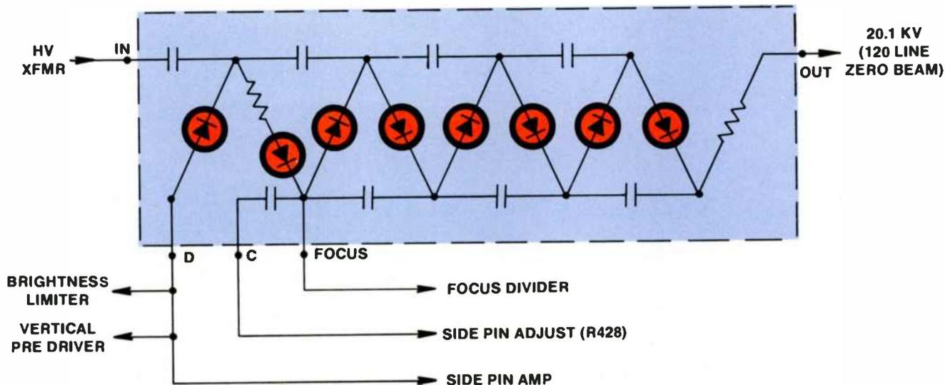
FIGURE 4-6 HIGH VOLTAGE QUADRUPLER
