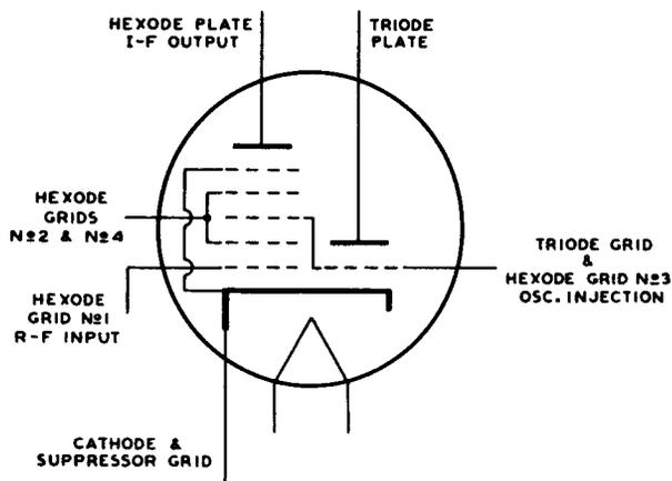
Fig. 7 - Triode-hexode converter (6J8-G).
