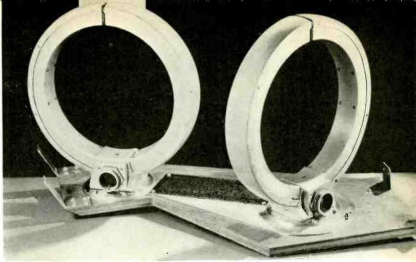
FIG. 1. THE LOOP UNIT OF THE SIMON RADIOGUIDE.
