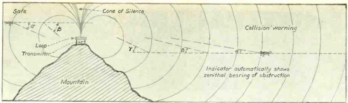
FIG. 4. UTILIZATION OF THE SIMON SYSTEM FOR COLLISION WARNING.
