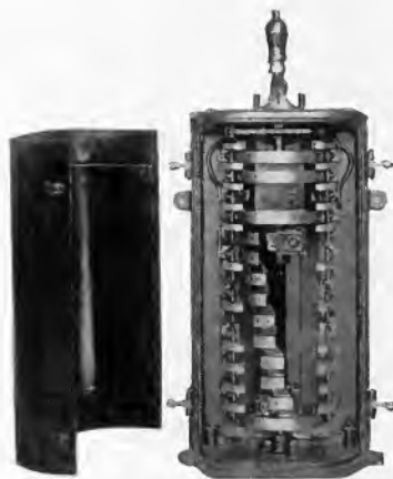
Fig. 18. Main Motor Controller
