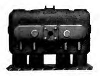
Fig. 1. Four Cylinders Cast En Bloc
