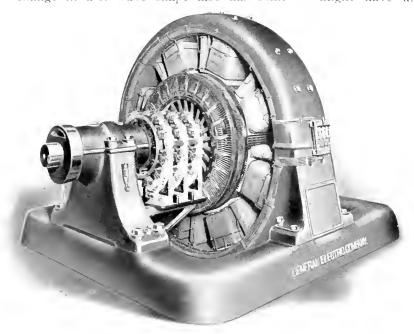
Fig. 4. Split Pole Converter
