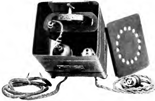
Fig. 39. 2-amp. 7.5-volt Tungar Rectifier
