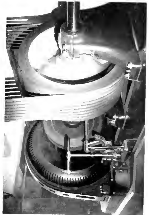
Fig. 3 100 k.v.a. Synchronous Motor Driving Fan Blower
