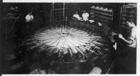
AUTOMATIC GLAZING MACHINE APPLIES A UNIFORM GLAZE OVER INSULATOR SURFACES
