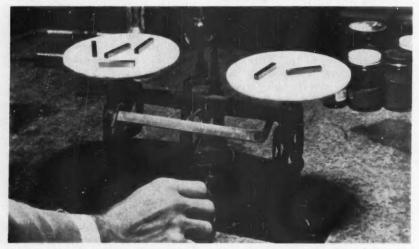
CHROME CARBIDE'S LIGHTNESS SHOWN HERE; FOUR BARS BALANCE TWO TUNGSTEN CARBIDE BARS
