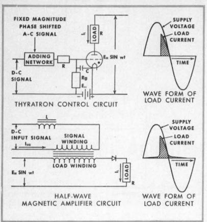
COMPARISON OF THE THYRATRON AND HALF-WAVE MAGNETIC AMPLIFIER CIRCUITS.
