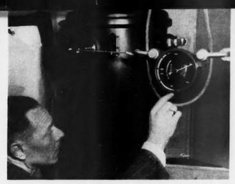
BUSHING CONNECTOR HOLDS ALUMINUM WIRE UNDER 200-POUND PULL.
