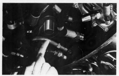
HIGH-TEMPERATURE ACCELEROMETER OPERATES IN AMBIENT TEMPERATURES OF  $-50\,\mathrm{TO}+500\,\mathrm{F}.$
