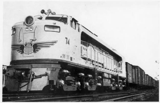
FIFTEEN MORE GAS-TURBINE ELECTRIC LOCOMOTIVES WERE DELIVERED TO UNION PACIFIC DURING 1954 FOR HIGH-SPEED FREIGHT SERVICE.
