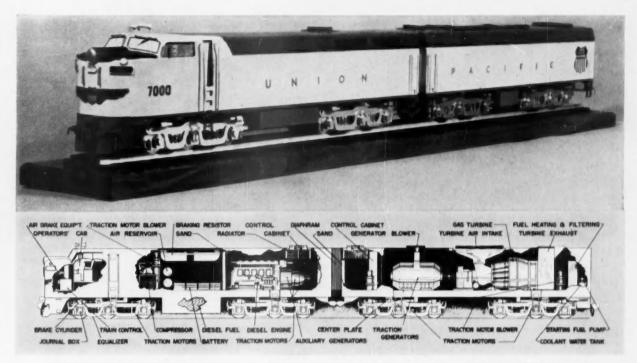
FIFTEEN 8500-HP GAS-TURBINE ELECTRIC LOCOMOTIVES (MODEL) WERE ORDERED BY THE UNION PACIFIC FOR DELIVERY IN 1957.
