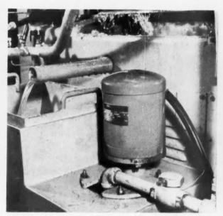
DRIPCOVERS PROTECT MOTORS FOR MACHINE-TOOL COOLANT PUMPS.
