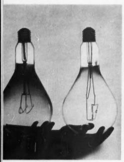
AXIAL FILAMENT INCREASES LIGHT OUTPUT.
