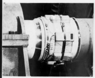
TORQUE TELEMETER TRANSMITS SIGNAL TO AN OSCILLOGRAPH.
