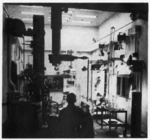
SPENT FUEL ELEMENTS TESTED INSIDE CELL ARE CONTROLLED OUTSIDE.
