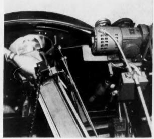
NEW MULTISHAFT GEAR-MOTORS OPERATE AUTOMATIC PIN SPOTTER.
