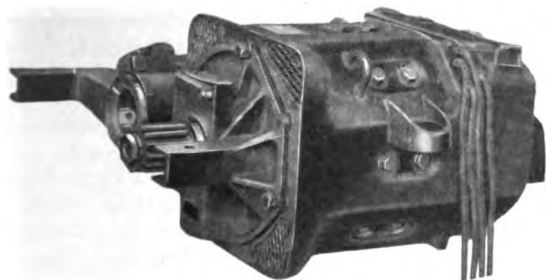
Fig. 4. GE264-A Motor (Suspension Side)
